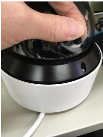
(1) ドームカバーのトルクスネジを隠しているゴムを外します。
