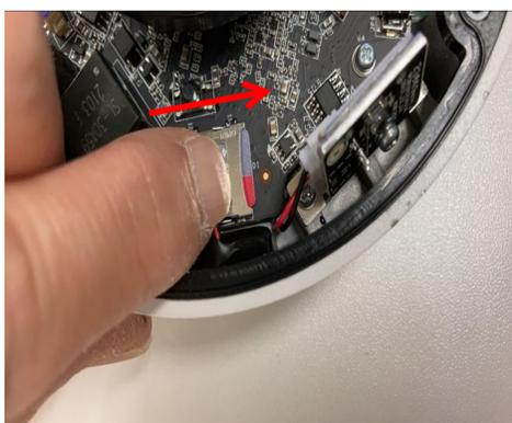
⑧microSDカードがロックされたことを確認してカメラのドームを取り付ける
