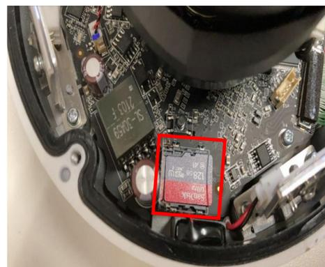
⑦銀色のストッパーを倒して、軽く押さえながら矢印の方向へスライドさせる
