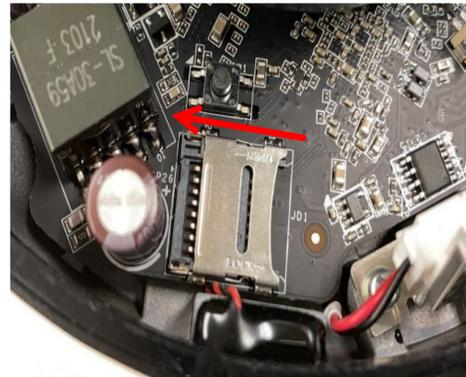
⑤矢印方向へ銀のストッパーをスライドさせるとロックが解除されるので、銀色のストッパーを起す⑥microSDカードのラベル面を上にしてくぼみにはめ込む
